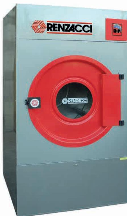
di essiccatori a circuito chiuso con totale recupero del flusso d'aria "RZ" plus, un grande esempio di originalità ed abbattimento dei costi operativi, che elimina completamente qualsiasi necessità di tubazioni di scarico esterne e/o costose ed ingombranti cappe di scarico.
