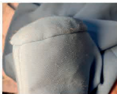
Bassa resistenza allo snagging (fili tirati e fuoriuscita peli) dei fili continui in acetate. Snagging (rottura dei filamenti) su capo in 100% acetato filo continuo Low resistance to snagging (pulled threads and hair spillage) in continuous acetate yarns. Snagging (filament breakage) on 100% acetate continuous yarn garment
