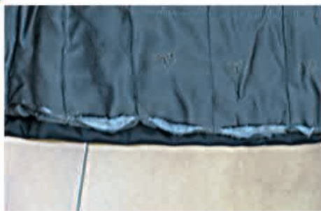
Orlo di una fodera in 100% acetato che si è strappata con l'usura da utilizzo Hem in 100% acetate lining that has torn from wearing
