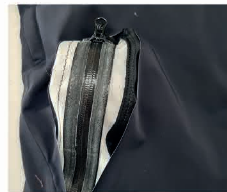
lacerazione della tasca per distacco del termoadesivo della cerniera jackets and coats made of textured polyester yarn
