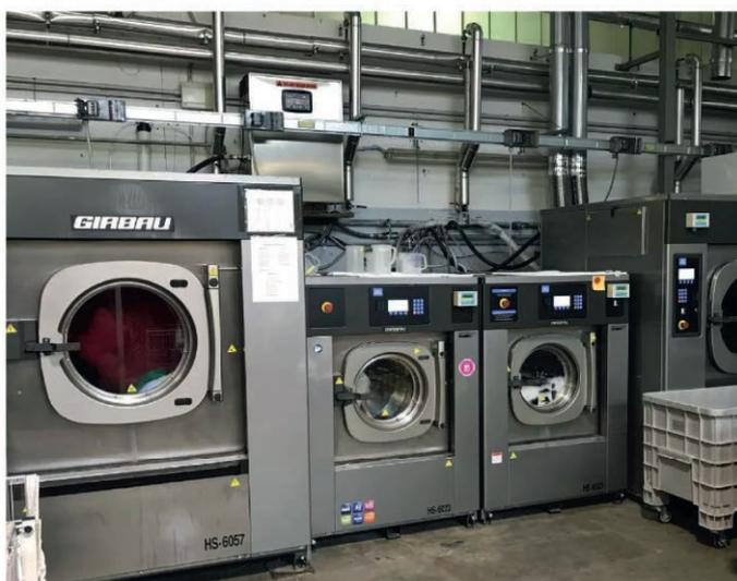
"Grazie a dei prototipi di macchine appositamente realizzati riusciamo a lavarle in acqua con l'utilizzo dell'ozono per garantire una sanificazione efficace.
