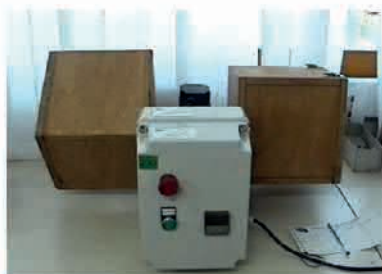
Apparecchio ICI box (ISO 12945-1/02) Pilling box ICI (ISO 12945-1/02)
