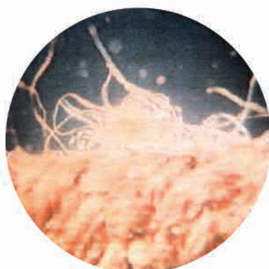
il pills non si stacca dal tessuto e si ingrossa sempre di più the pills do not detach from the fabric, and get bigger and bigger
