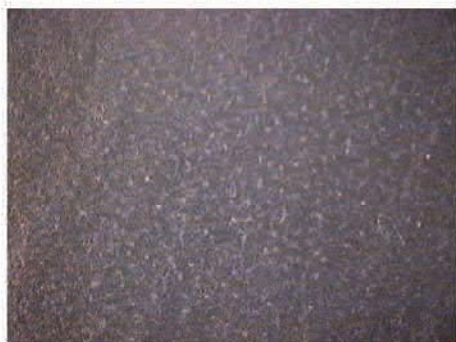
aspetto di un piumino in poliestere in ordito e cotone in trama per fuoriuscita del pelo bianco di cotone molto corto appearance of a down jacket in polyester warp and cotton weft, extrusion of very short white cotton fibres
