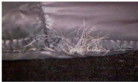
fuoriuscita piumino fibre di piuma e fibre di piumino dalle cuciture
