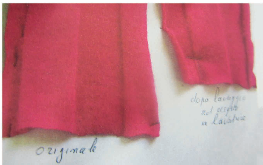
Rientro per infeltrimento a causa delle scaglie Felting shrinkage due to the scales
