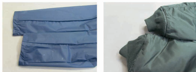
Il difetto si evidenzia nel raccorciamento delle maniche It can be noticed the sleeves shortening defect
