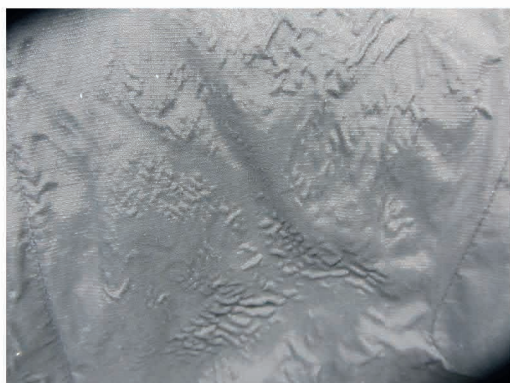
Distacco della lamina esterna dal supporto con formazione di grinze e ondulazioni Outer coating detached from its support, forming wrinkles and corrugations
