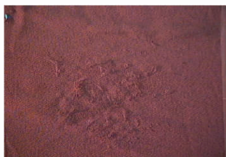
Formazione di gruppi di fibre o di fili che fuoriescono dal tessuto Formation of fibre clusters or threads spilling out from the fabric
