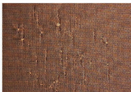
Distorsione dell'intreccio Interlacing distortion
