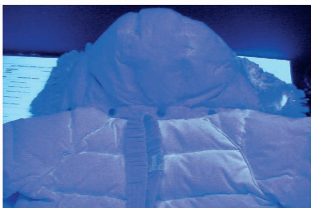
Capo lavato con ottico ad eccezione della cintura e del cappuccio, non lavato osservato sotto la luce di Wood Optically washed garment, excepting the belt and the hood, observed under Wood's light
